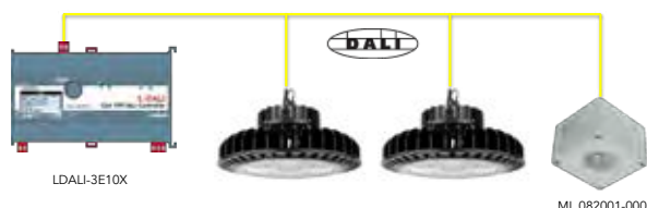
Solución con controlador DALI y multisensor LonWorks
