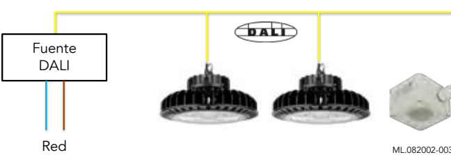
Solución autónoma con CLC integrado en Multilux High Bay DALI Master
