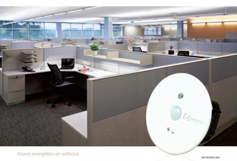
e-Multisensor 0-10V es un innovador multisensor que incluye un detector de movimiento y un sensor de luminosidad que informan del estado de ocupación y nivel de luz en una zona de un edificio. La información se envía a un sistema de control para la gestión de la iluminación y la climatización, con el objetivo de conseguir un ahorro energético óptimo de la instalación. El equipo se encarga de medir el nivel de luz y proporcionarlo al sistema de control para su tratamiento.
