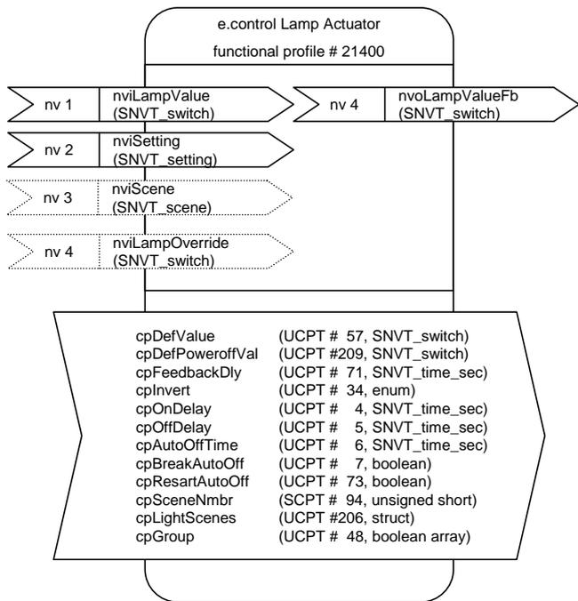
*nviScene*: bei Mehrfachaktoren als *nviGroupScene* auf Lamp Group Controller (#21500)
