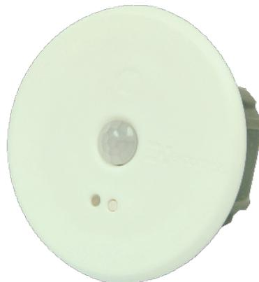
entrada digital de un sistema de control. La activación de la salida (cierre del contacto) se realiza por detección de movimiento y la desactivación por temporización desde la última detección válida. El temporizador se puede ajustar desde 5 segundos a 30 minutos mediante un potenciómetro.
